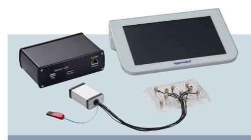
La verificación de temperatura con un sistema de múltiples sondas permite una evaluación rápida y fiable del rendimiento del termociclador. Los certificados generados documentan la cualificación del instrumento para su sistema de gestión de calidad.
