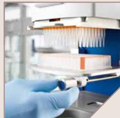
Si utiliza placas de 96 o de 384 pocillos al mismo tiempo, un manipulador de líquidos de 96 canales que se pueda utilizar tanto fuera como dentro de la cabina de bioseguridad es la solución perfecta para incrementar la precisión, la conformidad de la placa y la rapidez en procesos como los siguientes:
